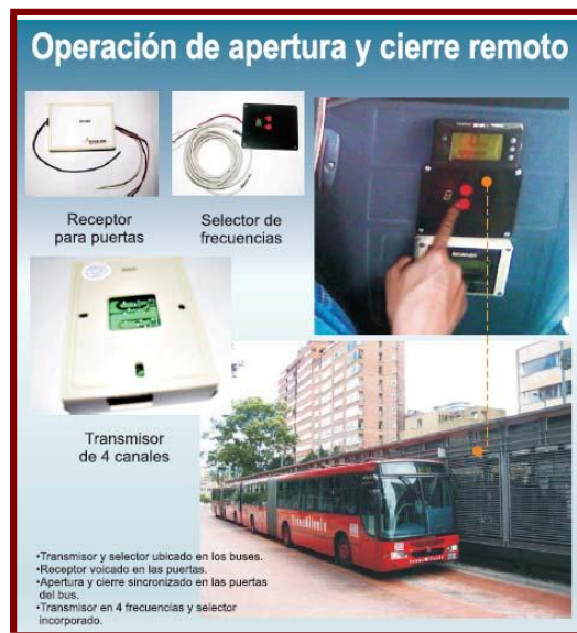
Figura 1.8. Descripción del funcionamiento del Sistema de puertas.
